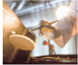
Vorbereitung: Bevor der Testschmutz aus Eigelb, Puderzucker und Alkohol aufgetragen wird, muss die Scheibe gründlich gereinigt werden. Eine Politur holt selbst hartnäckige Verschmutzung vom Glas
